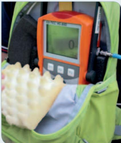
*Das Messgerät im Rucksack wartet aus, ob sich Methan in der Luft befindet, und schlägt notfalls Alarm.*
