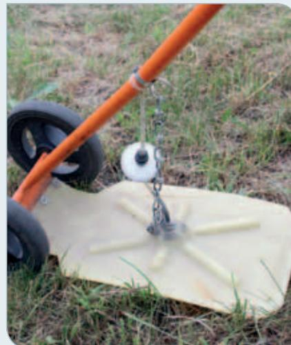
*Über diese sogenannte Teppichsonde wird Luft nah am Boden angesaugt.*
